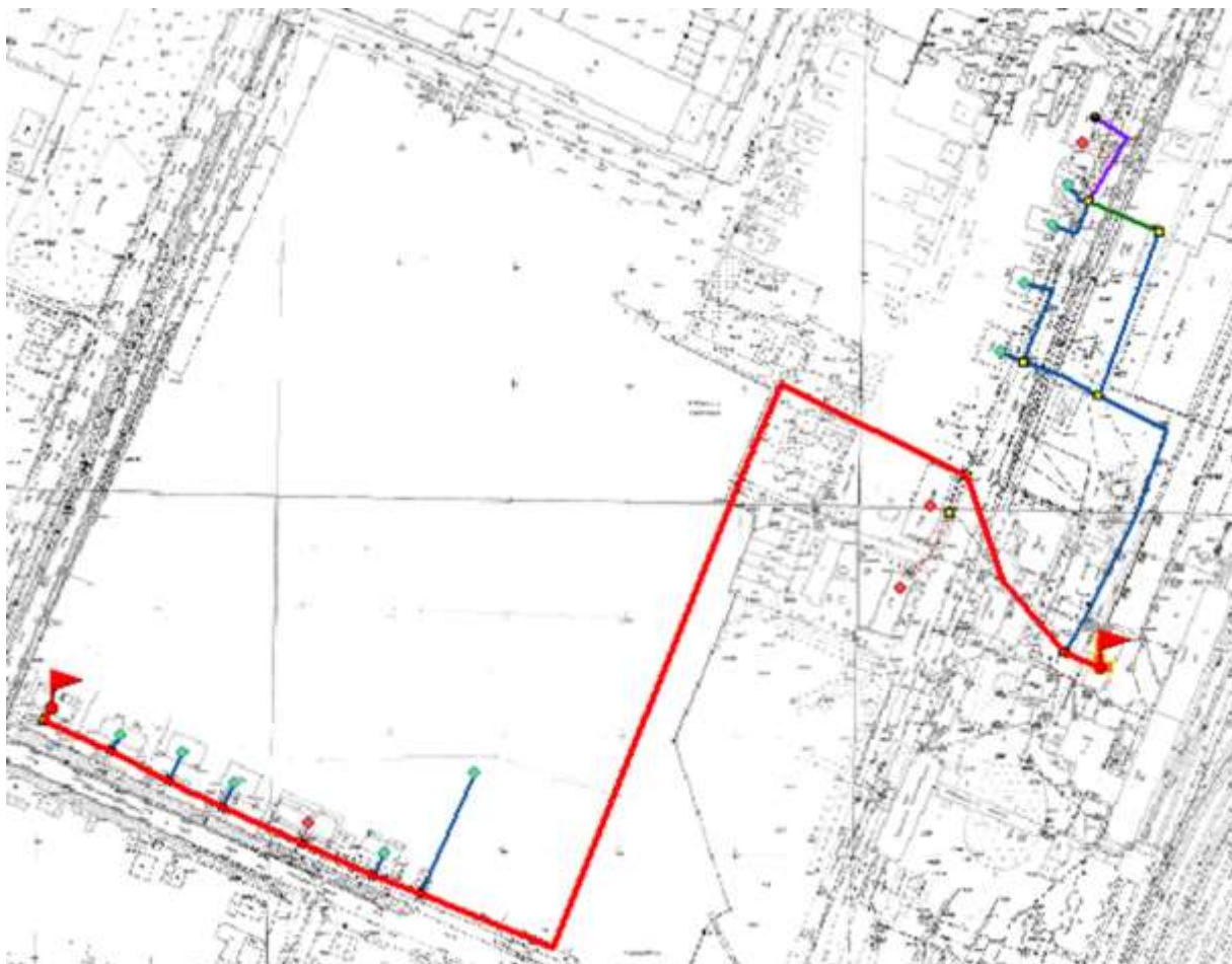
Рисунок 16 - Трассировка теплопровода от котельной № 11 до конечного потребителя «Ново-Егорьевский тракт, д. 12А» (расчетный путь 10-1)
