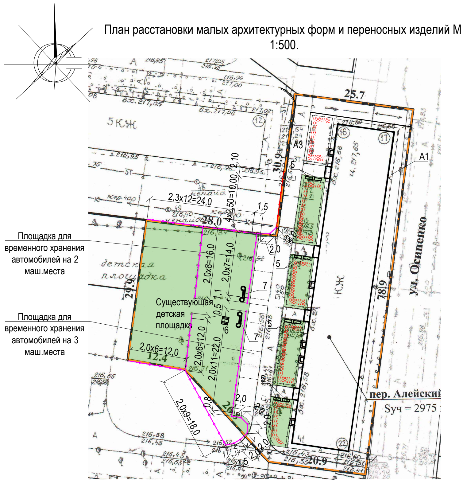
Схема установки столбов травмобезопасного ограждения
